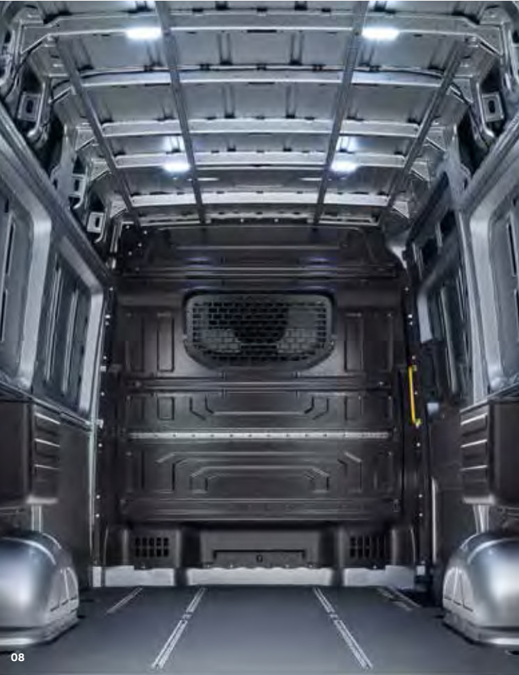
08 LED belső világítás.* Négy integrált LED lámpa biztosítja a raktér egyenletes és megfelelő megvilágítását.
