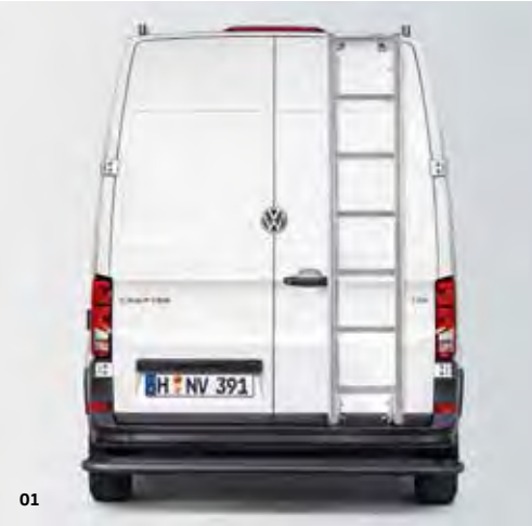
01 Létra a hátsó szárnyasajtón.* Gyors hozzáférést biztosít és meggyorsítja a tető meg- és lerakodását. A létra közvetlen rögzítésének köszönhetően a hátsó ajtószárny akadálytalan nyitása továbbra is biztosított. | DO |
