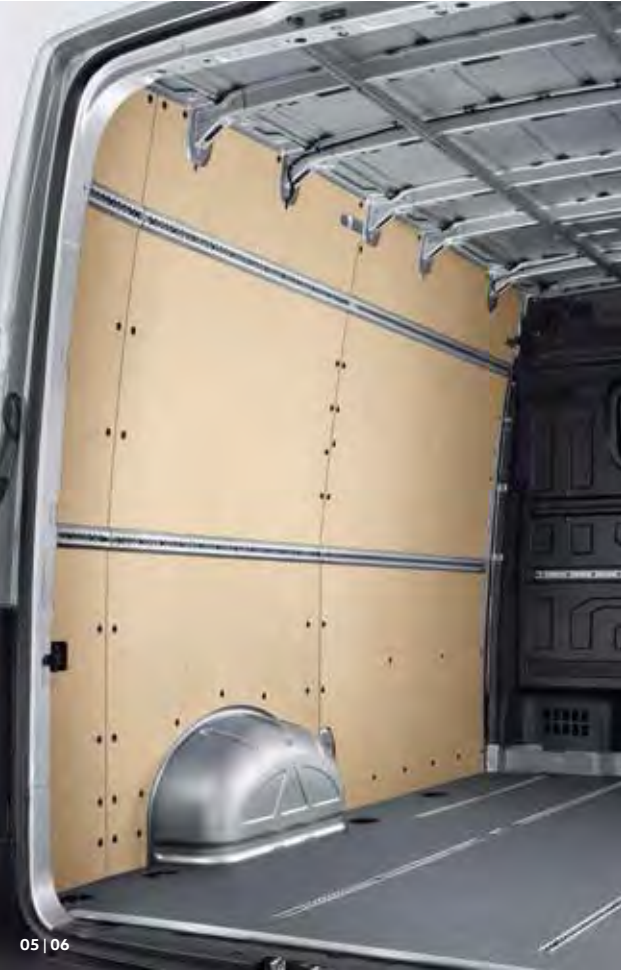
05 Tetőig érő oldalburkolat rétegelt falemezből.* Az 5 mm vastag rétegelt falemez különösen ellenállóvá teszi az oldalburkolatot.
