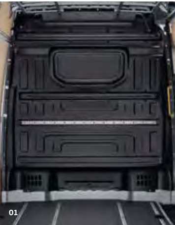
01 Elválasztófal ablak nélkül. A DIN 75410-3 szabvány szerinti válaszfal teljesen zárt. A vezetőfülke feletti mennyezeti rekesz külön rendelhető a magas tető kivitelhez, az extra magas tetőkivitel esetén viszont alapfelszereltség.
