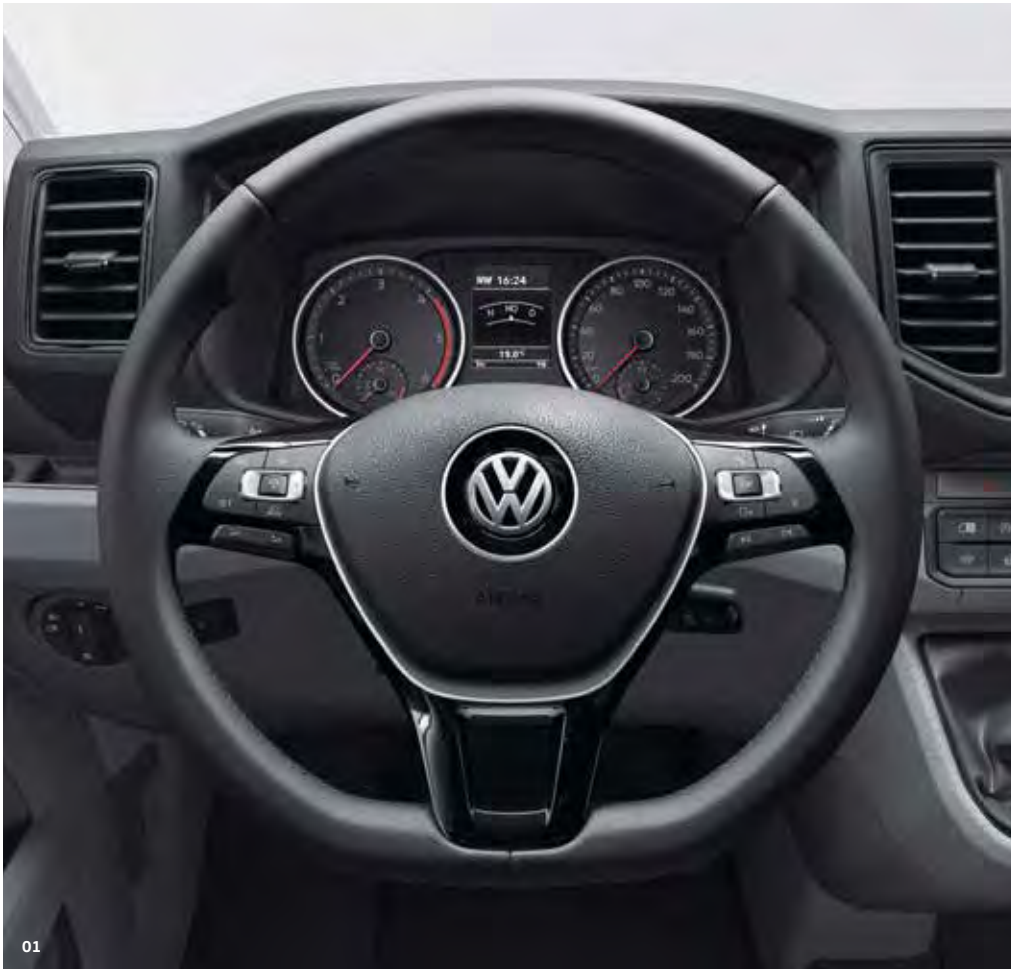
01 Bőrbevonatú fűthető multifunkciós kormánykerék. Ez a kormánykerék különösen kellemes tapintású és rendkívül kényelmesen kezelhető. A gombok segítségével vezérelhető pl. a rádió vagy a navigációs rendszer, a mobiltelefon és a sebességszabályozó berendezés. | DO | KO | PL | AL |
