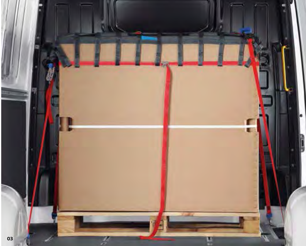
03 Rakományrögzítő háló. Egy körbefutó heveder gondoskodik a rakomány megbízható rögzítéséről. A karabineres kampókkal felszerelt racsnis heveder a jármű rögzítési pontjaiba vagy a sínrendszer külön rendelhető szerelvényei segítségével rögzíthető. | DO |
