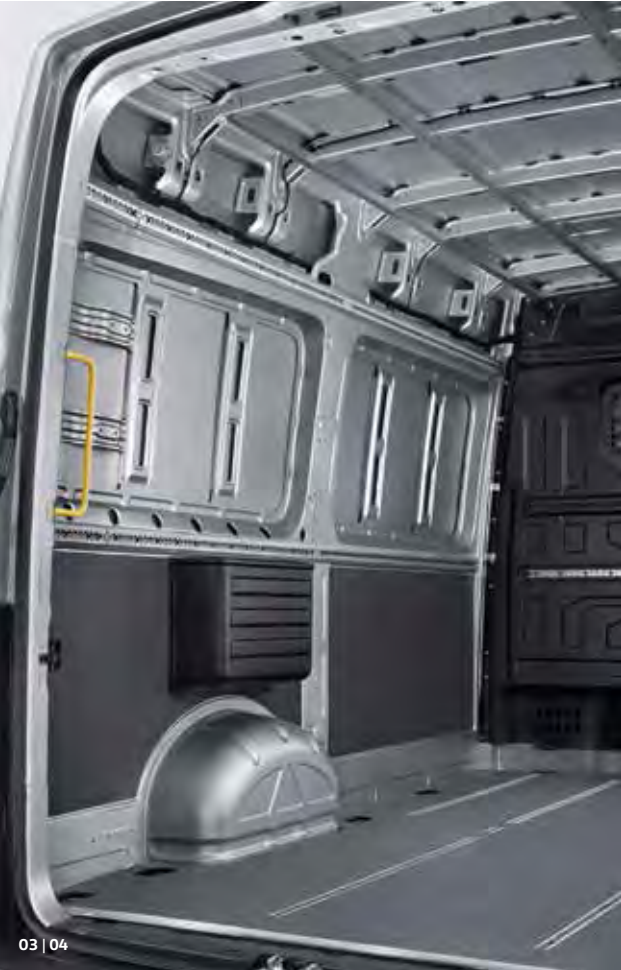
03 Félmagas oldalburkolat üreges műanyag lapokból.* A raktér üreges műanyag lapokból készült burkolata különösen robusztus. Az oldalburkolat a padlótól a középvonalig ér, és rendkívül könnyen tisztítható.
