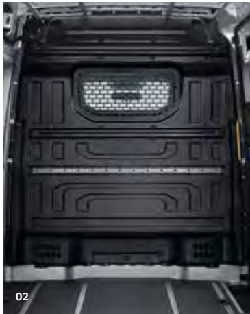
02 Elválasztófal ablakkal és védő-ráccsal.* Az ablak egyedülálló ferde beállítása megakadályozza, hogy a vezető látóterébe visszaverődések jussanak. A rács egyszerre óvja az ablakot, a vezetőt és a vezető mellett ülő utast, például hirtelen fékezés esetén. Az ablak kétféle változatban rendelhető: zárt válaszfalablakként vagy elhúzható ablakként.
