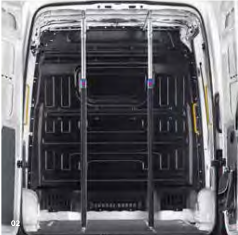
02 Két feszítőrúd. A különböző rakományok biztonságos szállítását teszi lehetővé. A raktér rugalmas kihasználása érdekében a feszítőrudak gyorsan behelyezhetők és kivehetők. | DO |
