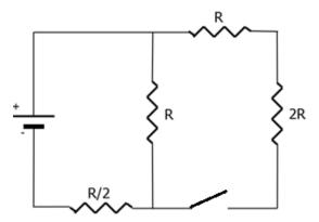
3. Dato il circuito in figura con  $\varepsilon = 15 \ V$  ed  $R = 6,0 \ \Omega$ , calcola la resistenza equivalente del circuito e la corrente erogata dal generatore ad interruttore chiuso. Come cambia la corrente se, invece, l'interruttore è aperto?
