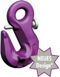
Verkürzungshaken mit Öse und Sicherung PS/S gegen unbeabsichtigtes Aushängen der Kette. Erster Parallelhaken in Grad 10 am Markt – Reduktion der Tragfähigkeit bei 4-facher Sicherheit nicht erforderlich.
