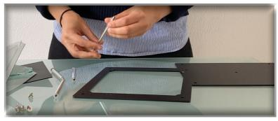
> Retirer les 4 vis des 4 tiges métalliques ainsi que les 4 protections cylindriques transparentes associées
