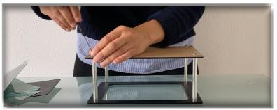
> Poser l'élément inférieur au bout des tiges (côté mat contre la table) puis visser les 4 côtés à l'aide du tournevis
