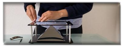
> Coller les grands œillets en-dessous et les petits au-dessus, sur les tiges métalliques.
