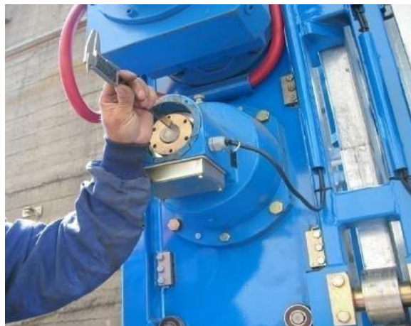
Fig. 12-17 Soltar la tapa y medir la distancia entre Tuerca y Husillo
