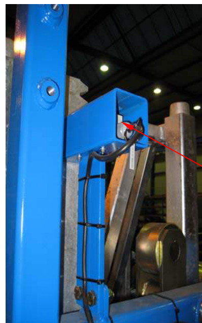
Fig. 2-35 Detector Presencia de Mástil
