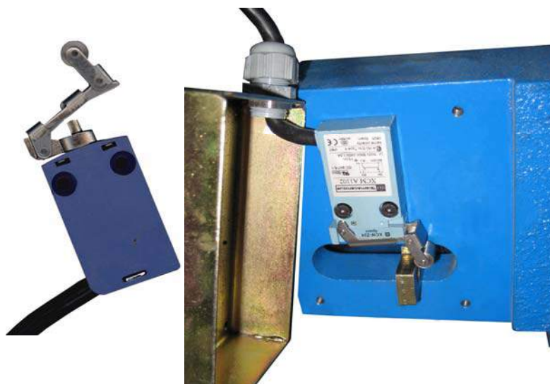
Fig. 12-12 Micro Paracaídas Tipo A
