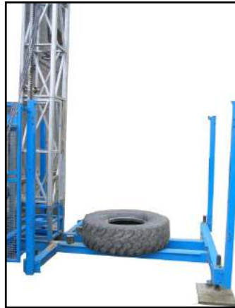
Fig. 12-16 Elemento de amortiguación: rueda de camión
