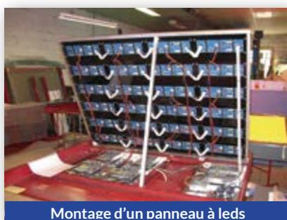
Montage d'un panneau à leds
