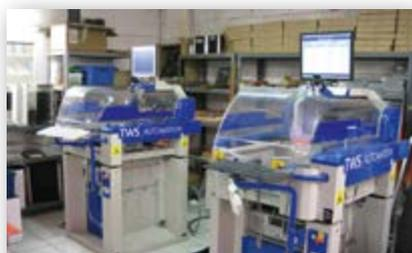
Robots pour l'implantation des composants (à gauche) et pour l'implantation des leds (à droite)
