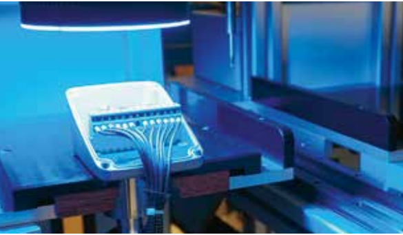
SF 6 -Gasdichtewächter werden individuell eingestellt und auf Genauigkeit überprüft.
