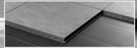
Feinsteinzeug mit der Einfachheit eines innovativen Klicksystems mit Nut-Feder Verbindung und umlaufender Fuge (2mm).
